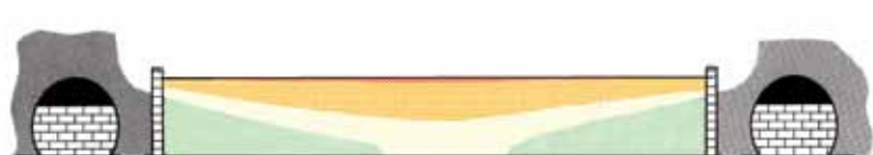
Zcela otevřený až částečně uzavřený tunel. Prostor vystavený průvanu je chladný, s nízkou vlhkostí.
